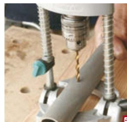
● El soporte móvil, de Wolfcraft, fabricado en aluminio, es muy ligero. Se fija al taladro introduciendo éste en el gollete de la parte superior que se aprieta con una llave Allen. Sirve para todo tipo de taladradoras.
